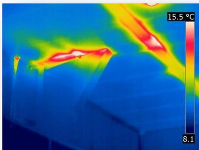
Irrégularité dans l'isolation - ponts thermiques
